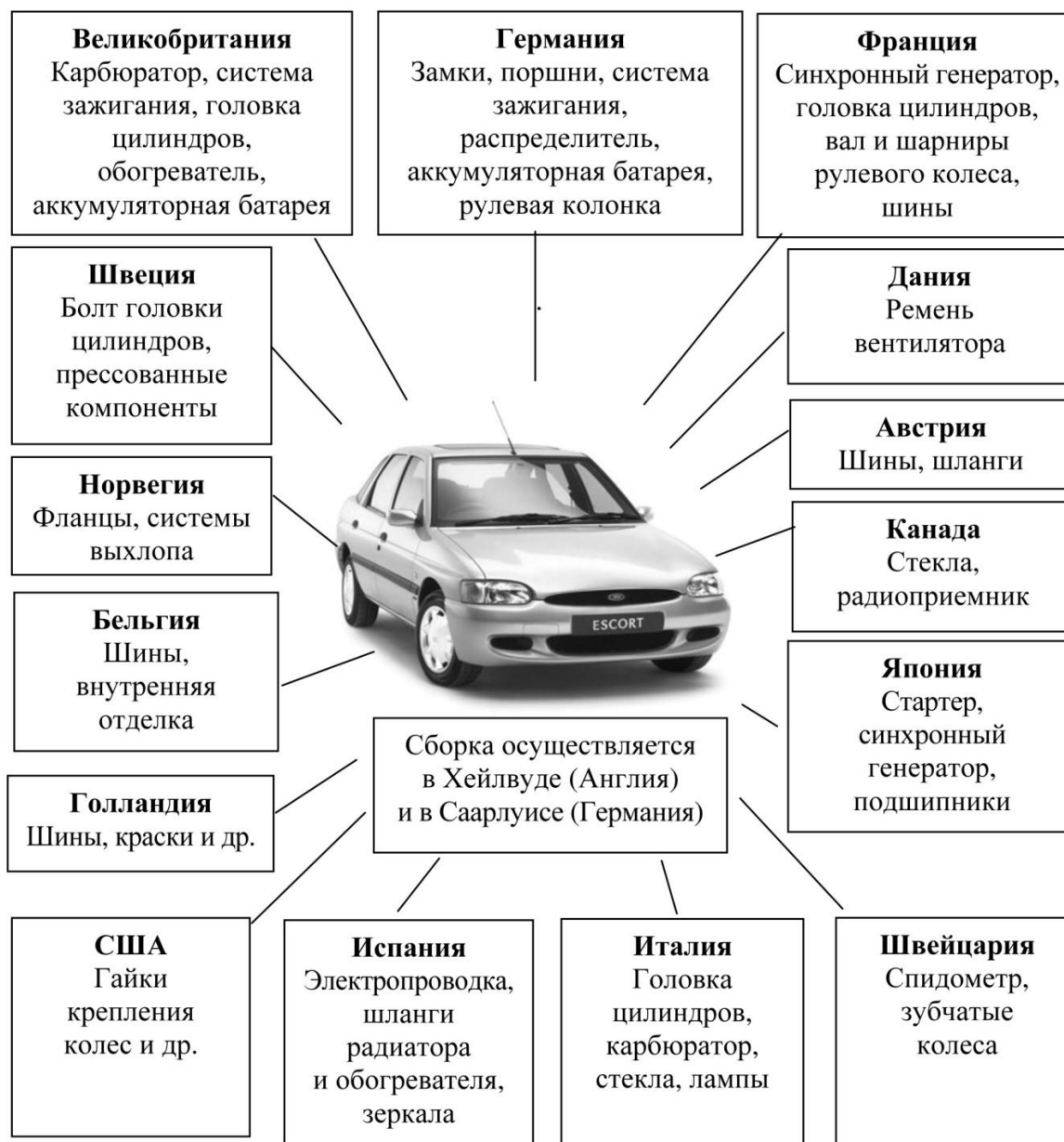
Рис. 20.5. Сеть изготовления комплектующих и самого автомобиля «Форд-Эскорт» для Европы
